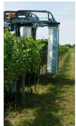
È importante la **facilità di regolazione della macchina irroratrice**, in funzione di fattori ambientali e delle caratteristiche della vegetazione.
